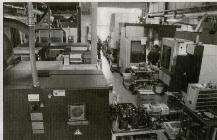
横中ぐり盤、同時5軸マシニングセンタ、複合旋盤、平面研削盤など、5年計画で最新の設備に入れ替えたので、外注しない単品や小ロットにも短納期で対応できる。
